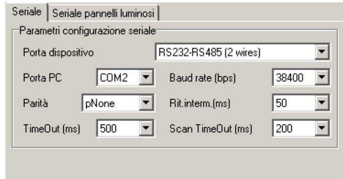
Parametri necessari per configurare la porta seriale del PC collegata all'apparecchiatura in modalità locale e slave.
