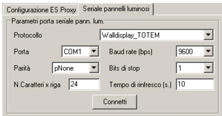
Parametri necessari per configurare la porta seriale del PC collegata al pannello luminoso (wall display).
