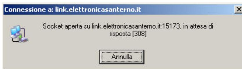
L' esito positivo della connessione si verifica alla chiusura della finestra ed alla comparsa sulla barra di stato del seguente messaggio: `Es851 con MAC:00-50-C2-44-A0-08 è connessa`.
